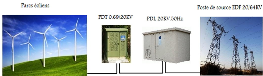
Figure (IV.2) : Schéma de principe du raccordement des éoliennes au réseau.
