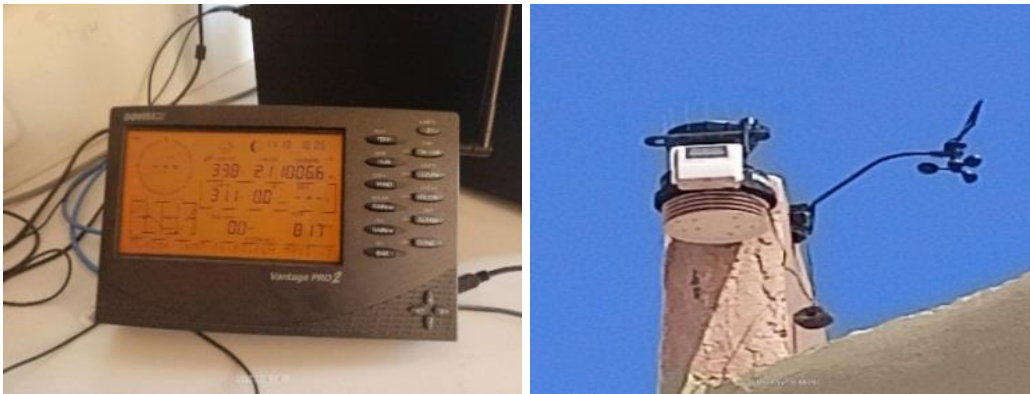
Figure III.1 Station météo de marque Vantage
