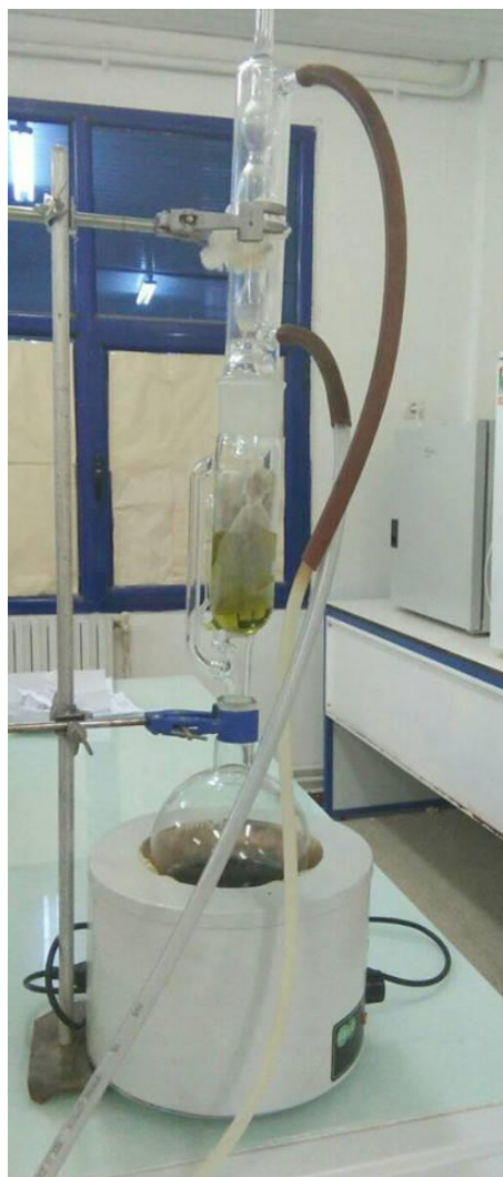
Figure II.4 : montage d'extraction par soxhlet
