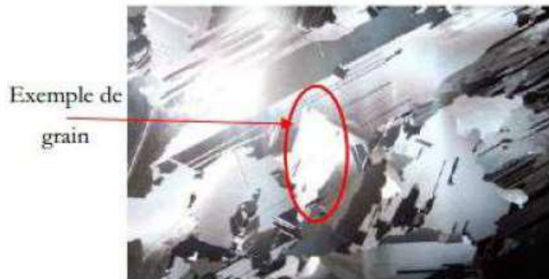
Fig. I. 4 Photo d'un substrat de silicium poly cristallin (échelle : 10×10 cm 2 ) [7].
