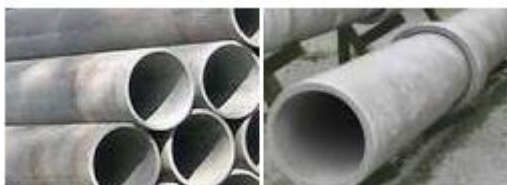
I .Figure 16 : photo tuyaux en amiante ciment.
