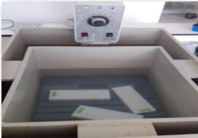
Figure III- 22: le bassin de solution de test MACHU.
