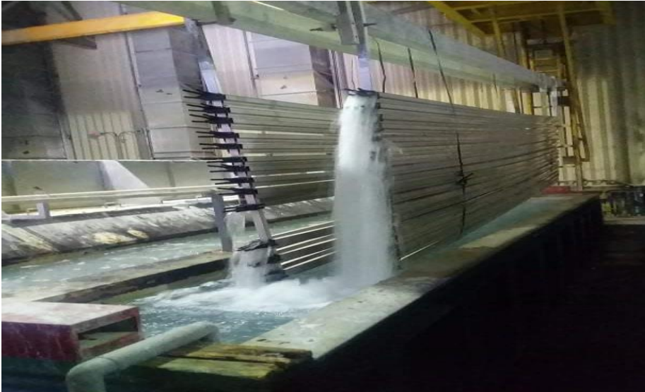
Figure III- 11:Sortie de profilés du bassin d'acide sulfurique.
