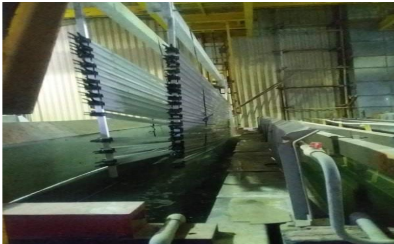
Figure III- 10:l'opération de dégraissage.
