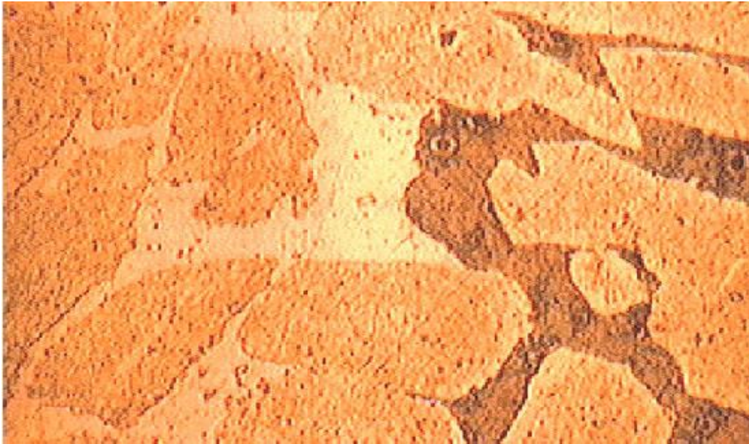
Figure I .2.4 La corrosion sélective
