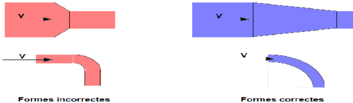
Figure II.3. Diminution du risque de corrosion-érosion d'un coude.
