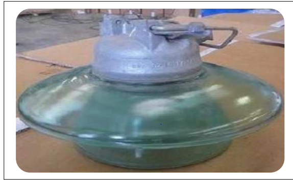
Figure 1.3 Isolateur rigide en verre
