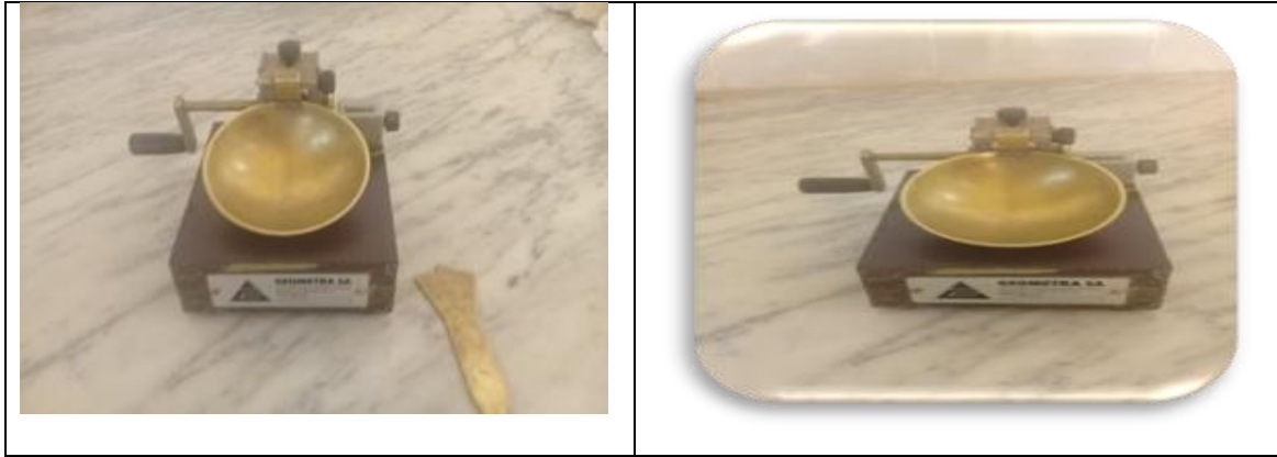
Figure. 23. Dispositif d'essai de limite de liquidité (appareil de Casagrande)
