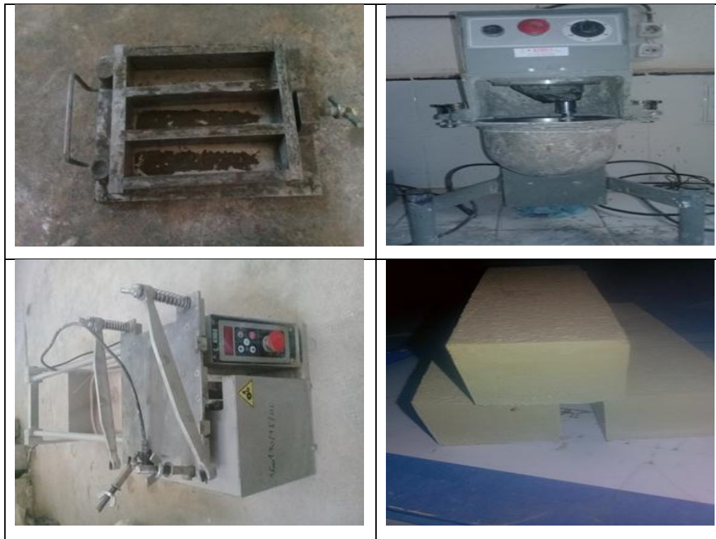
Figure. 27. Étapes de préparation des composites
