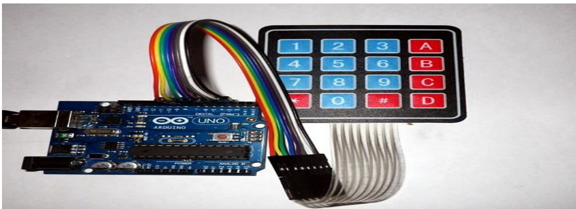
figure III- 17 : Câblage 4x4 Keypad avec Arduino
