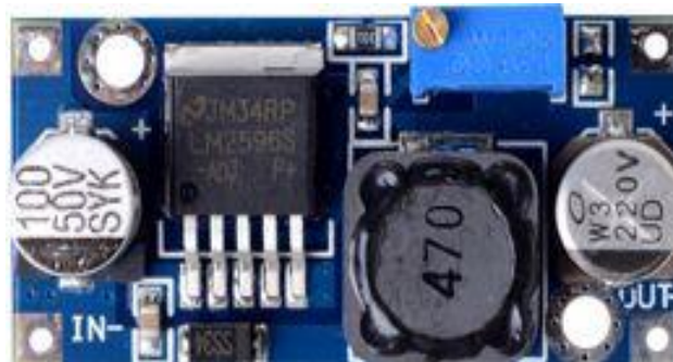
Figure I- 9 : Convertisseur abaisseur DC-DC LM2596
