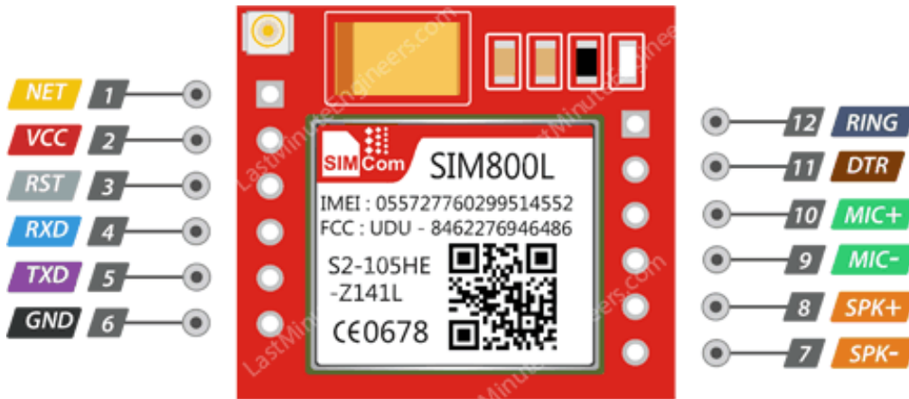
Figure I- 10 : Les pines de module GSM SIM 800L
