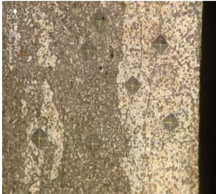
Fig III.10 : Empreintes de dureté sur l'échantillon Anodisé (couche-substrat)
