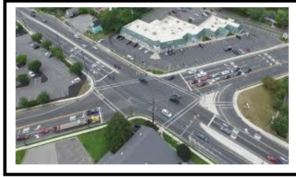
الشكل 10.1: تقاطع مائل على شكل حرف (X)
