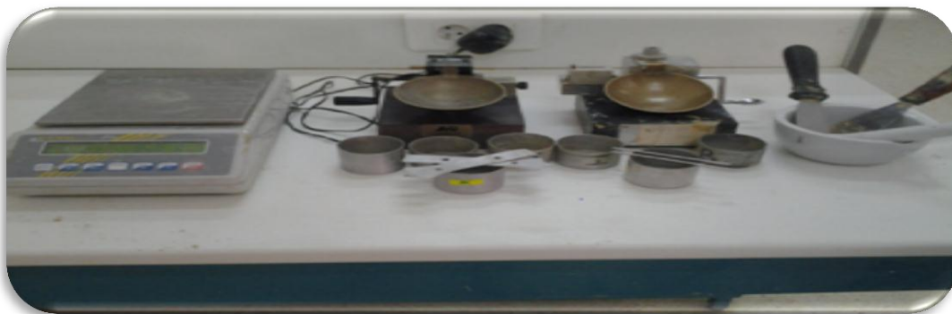
Fig. II.07: Appareil de Casagrande et matériel de la limite de liquidité
