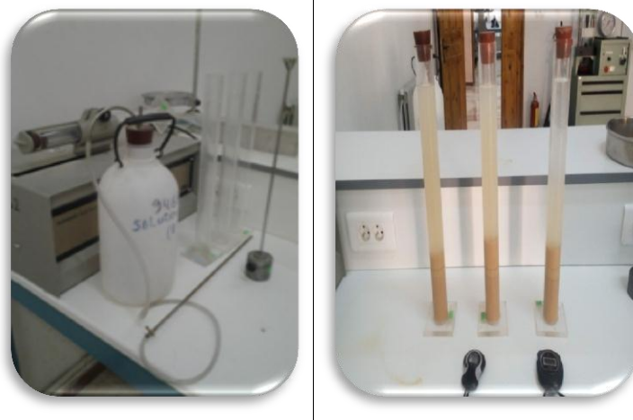
Fig. II.06 : mode opératoire de l'équivalent de sable.
