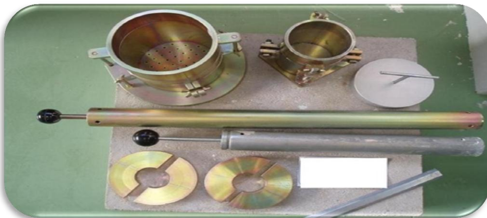
Fig. II.11 : Appareillage spécifique pour essais de compactage (Proctor Normal).
