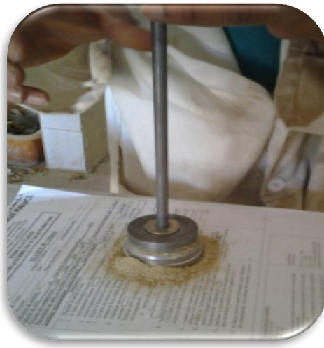
Fig.III.06: Mode opératoire de l'essai œdométrique
