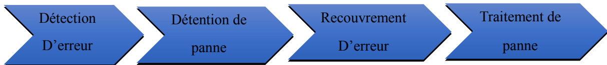
Figure 2.1 Procédure générale de tolérance aux pannes.
