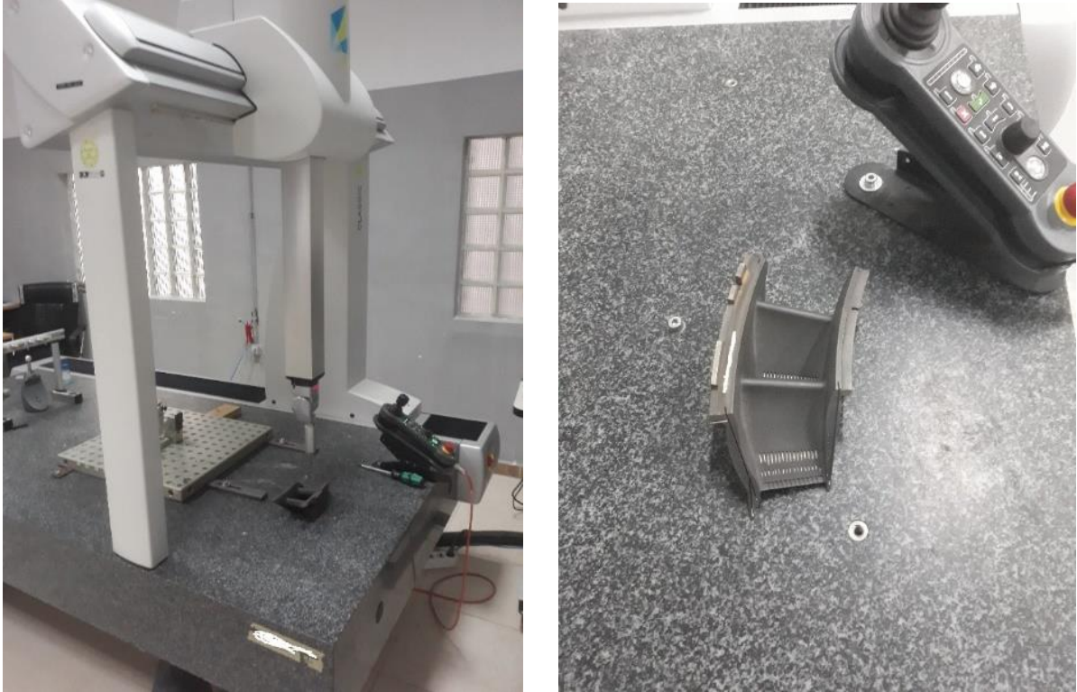
Figure V.23: Emplacement de la pièce sur le marbre de la MMT
