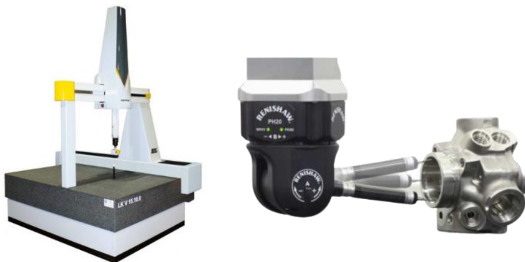
Figure II-4: Numérisation 3D par machine à mesurer tridimensionnelles (MMT)
