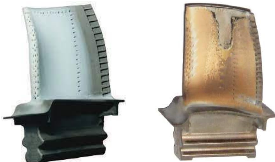
Figure I.1 : Rétro-conception d'une aube de turbine usée
