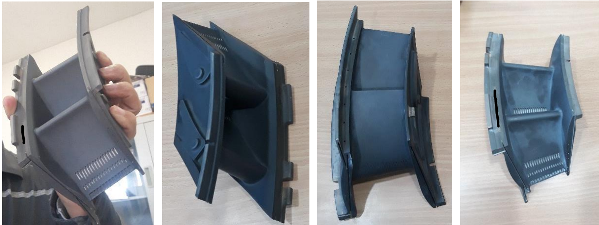
Figure V.4: la pièce à étudier (ailette turbine fixe partie chaude)
