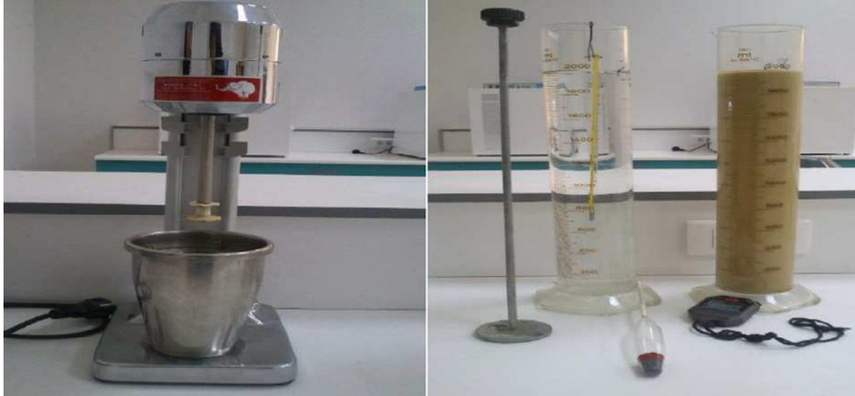
Figure 2.2. Essai Analyse granulométrique (par sédimentométrie).
