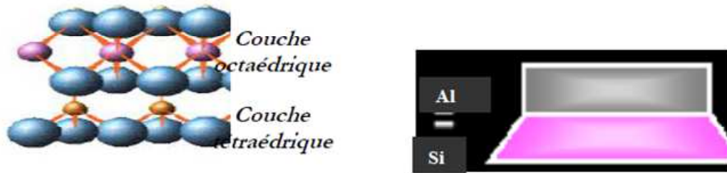
Schéma de la structure élémentaire de la kaolinite Lambe (1953).
