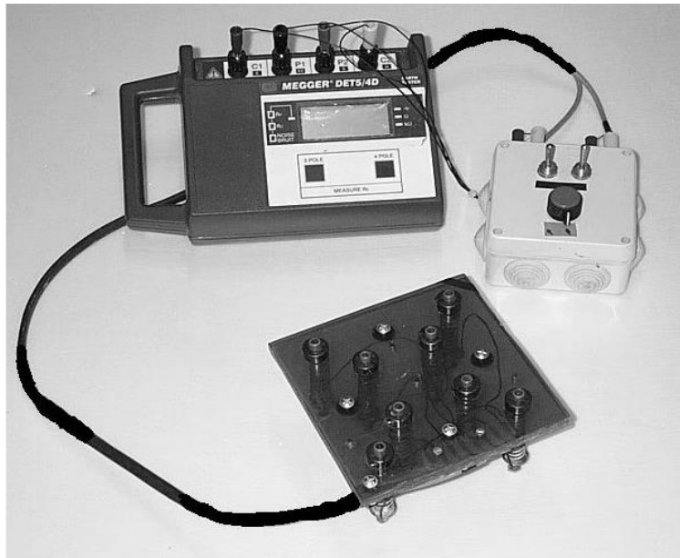
Figure (II-9) : Exemple d'un dispositif de mesure par quadripôle carré, Lataste (2002).
