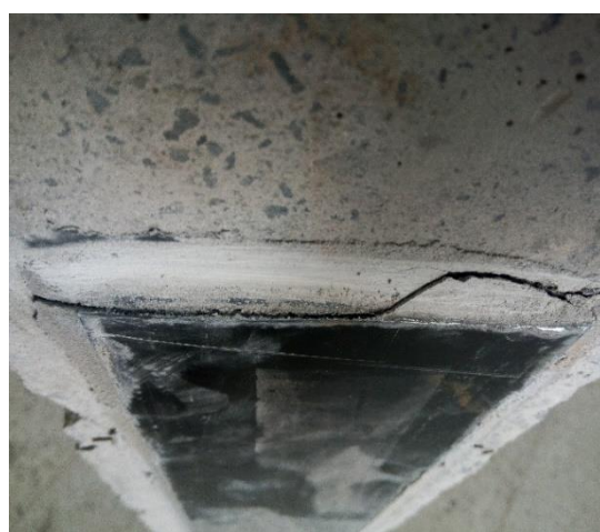
Figure (VI-5) : Mode de rupture par cisaillement des poutres renforcées par M1
