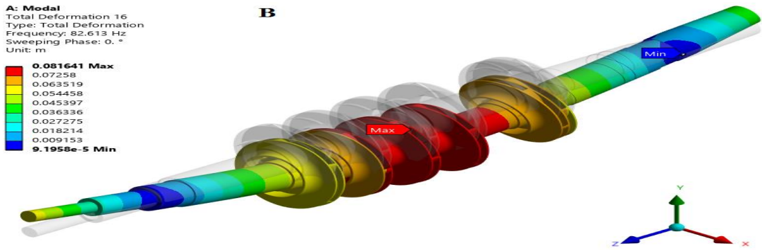
Figure III.19 : Formes de mode à une vitesse de rotation de 4000 tr/min : (B : Mode 2)
