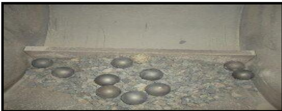
Figure IV: .3: L'échantillon et les boules avant l'essai.
