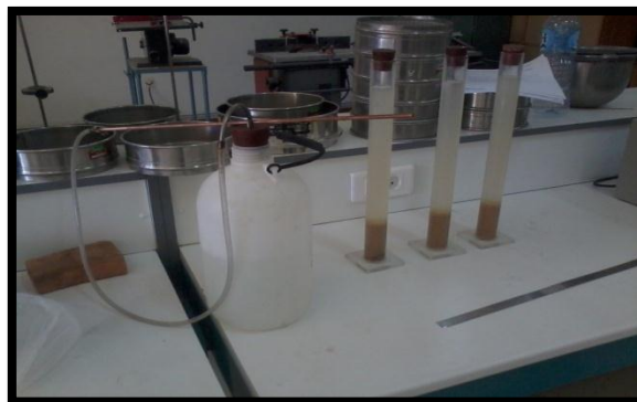
Figure. IV.5 : Essai équivalent de sable.
