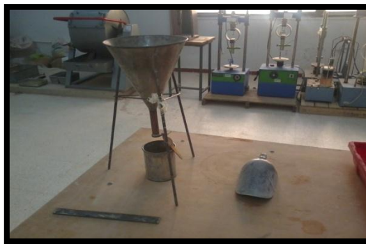
Figure IV.6: Matériel utilisé dans la masse volumique apparente.
