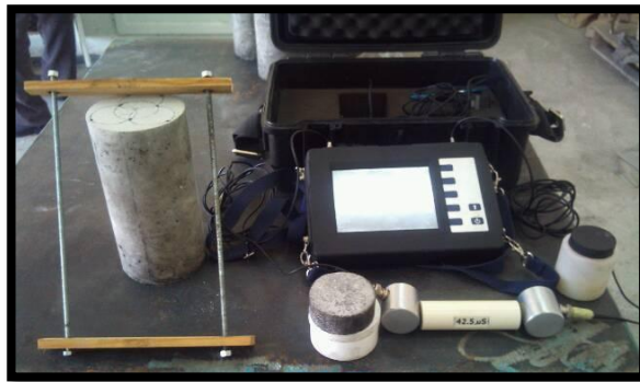
Figure IV.17 : Essai d'ultrasons et ses équipements.
