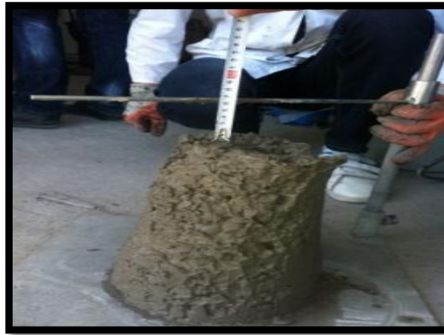
Figure IV.15 : Mesure de l'affaissement.
