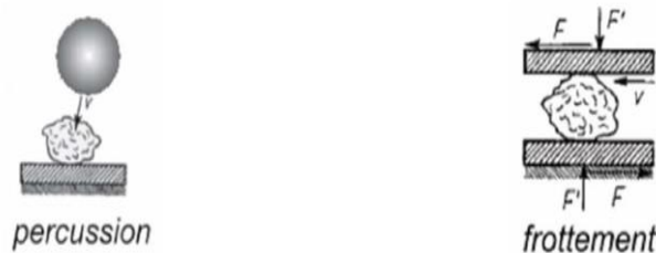
Figure I.6: Modes de broyage d'un grain de poudre dans un broyeur à boulet.[5]
