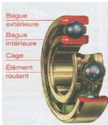
Figure I. 5 : Constitution d'un roulement à billes
