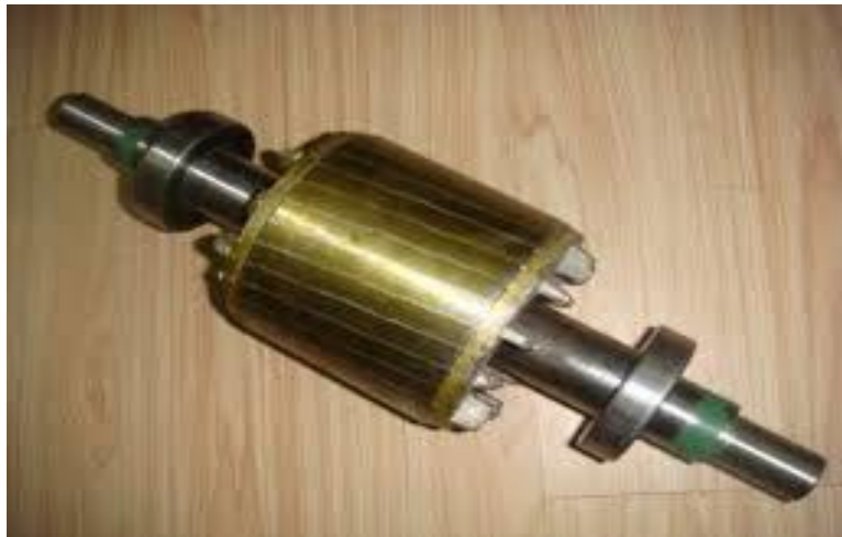
Figure I.3: Rotor à cage d'écureuil.
