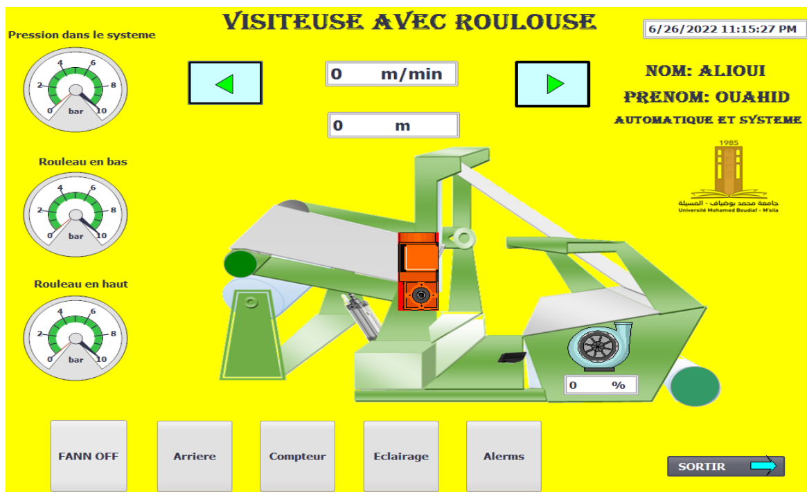
Figure (32): Supervision par WINCC Runtime
