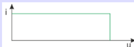
Figure III -10 : Alimentation régulée en courant.
