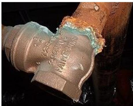
Figure I-5 : Corrosion galvanique résultante d'un assemblage de deux métaux différents : robinet en cuivre et conduite en acier galvanisé.
