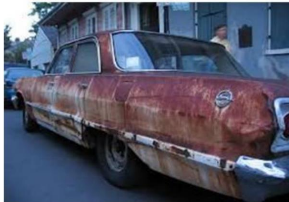
Figure I-4 : La corrosion uniforme exemple d'une d'une porte et d'un véhicule corrodés.
