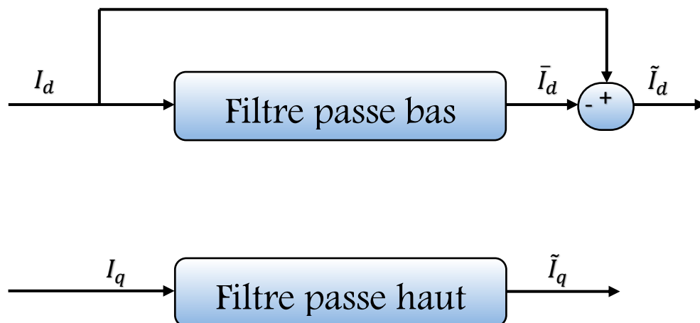
Figure III.4 : Schéma de principe de séparation des composantes continues et alternative
