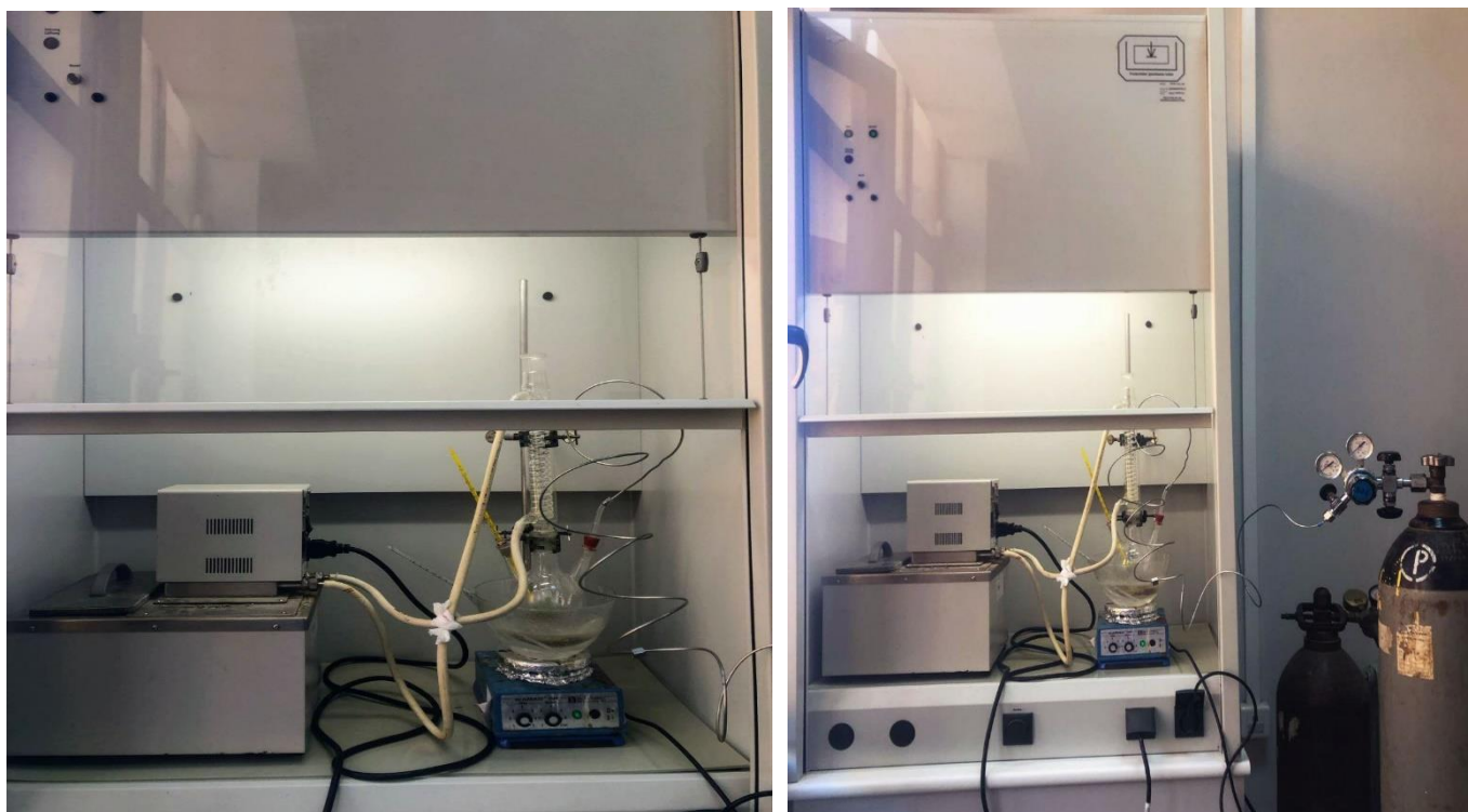
figure II.2: Montage expérimental de la polymérisation in situ .
