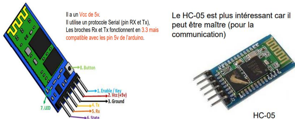
Figure IV.24 : Module Bluetooth HC-05 avec explication d'alimentation [17]
