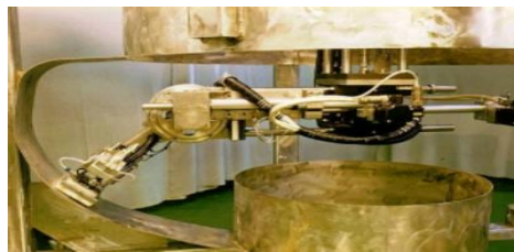
Figure. I.8: Robot de décontamination d'une pompe de circulation dans le nucléaire.
