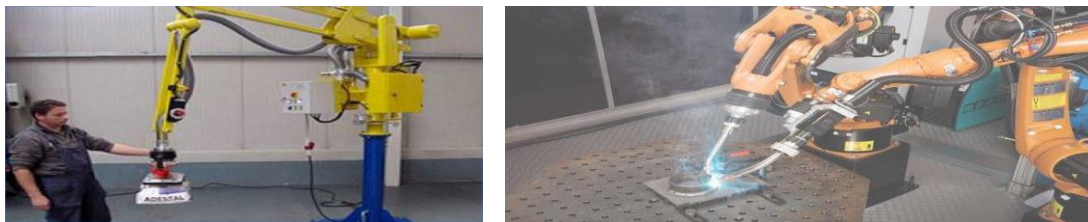
Figure.I.15 : Manipulateur à commande manuelle à gauche et a commandé automatique (kuka-robot de soudage à l'arc).
