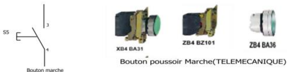
Figure IV.15 : Schéma électrique et présentation Bouton poussoir marche [14]
