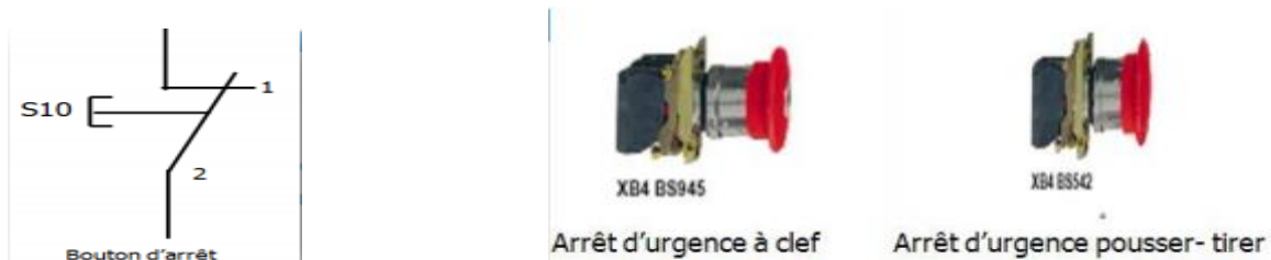
Figure IV.17 : Schéma électrique et présentation Bouton poussoir d'arrêt [14]
