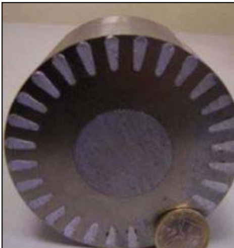
Fig.1.5.a Coupe d'un rotor à cage à encoche profonde
