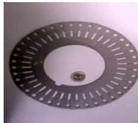
Fig.1.5.b Tôle utilisée pour la réalisation d'une cage à double encoches
