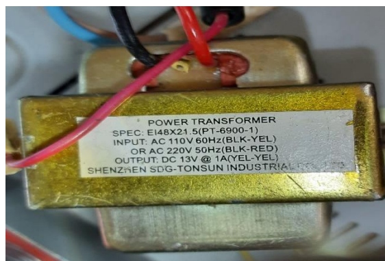
Figure II.5 : Image d'un transformateur de type EI48X21.5 (PT-6900-1).
