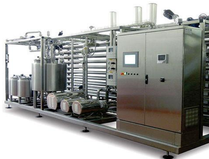
Figure 2 : Stérilisateur tubulaire des produits laitiers (www.directindustry.fr)
