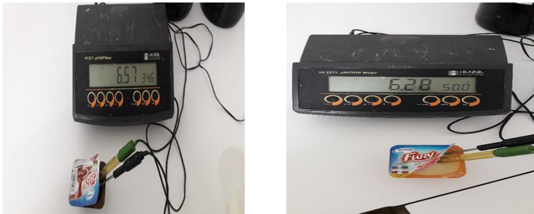
Figure 5 : Détermination de pH par le pH-mètre
