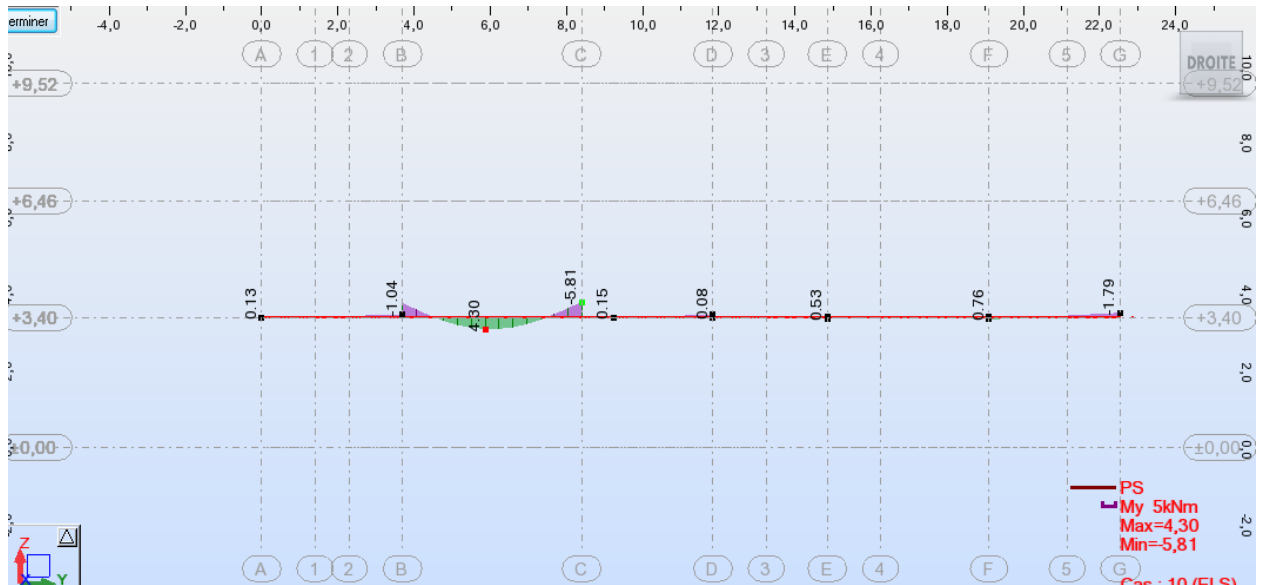
Figure 4.18 : Moments fléchissant dans les poutre secondaires ELS
