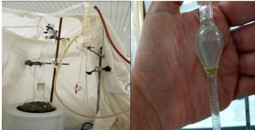
Figure III.1. Montage d'extraction de l'huile de lavande par Clevenger
