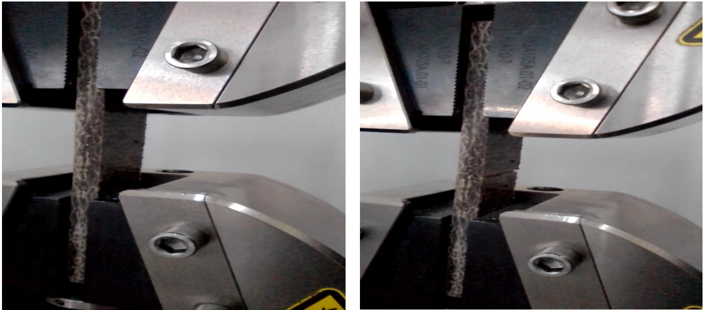
Fig.III.11: Eprouvette soumis à la traction.
