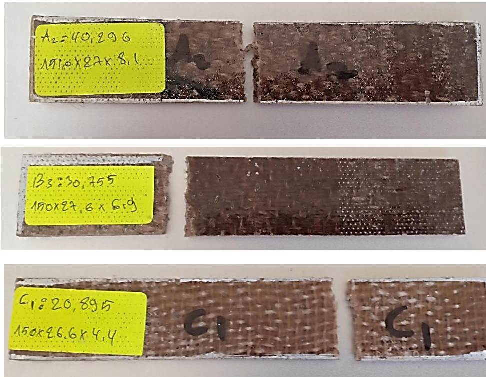
Fig. IV. 5 Rupture des bio-composites
