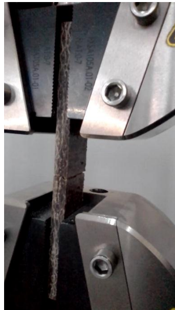
Fig. IV. 1. Rupture du composite Jute/Polyester durant l'essai de traction.
