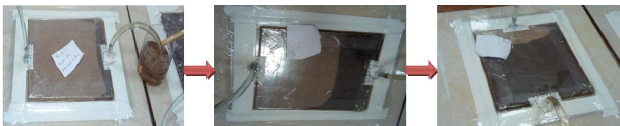
Fig. III. 7. Le processus de passage de la résine.
