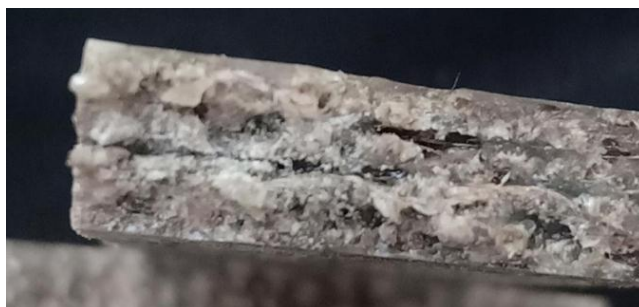
Fig. IV. 9. faciès de rupture des composites jute/polyester
