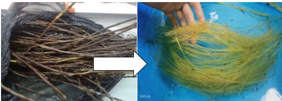
Figure. III. 2. Extraction chimique par rouissage au bicarbonate de sodium ( \text{NaHCO}_3 )
