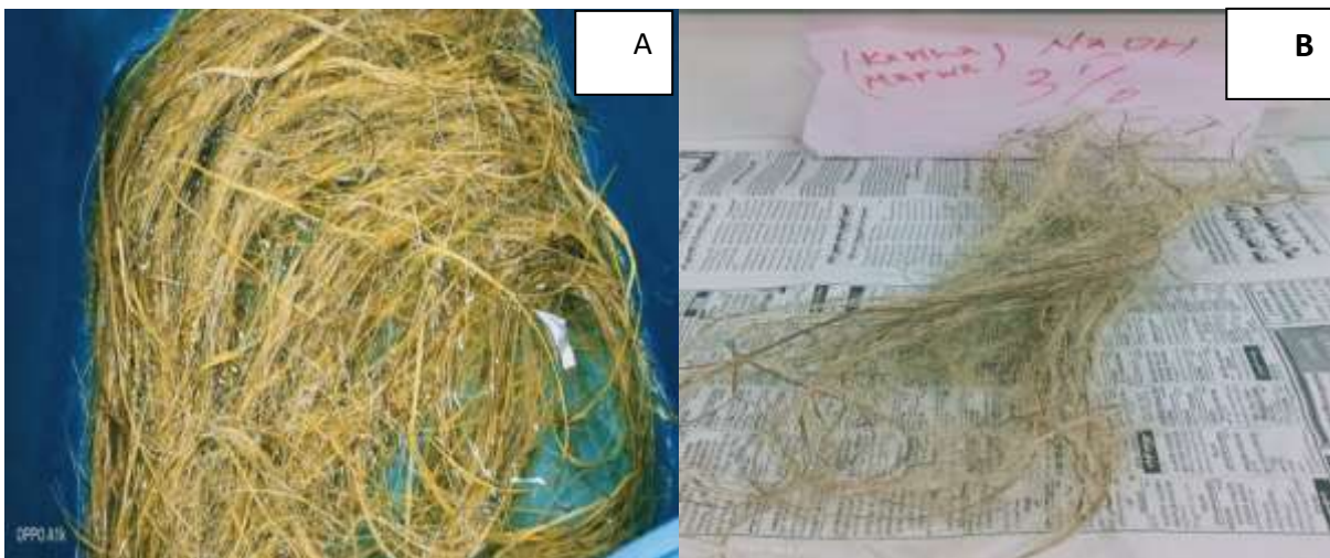
Figure. III.5. Le traitement par l'hydroxyde de sodium (3% NaOH)
