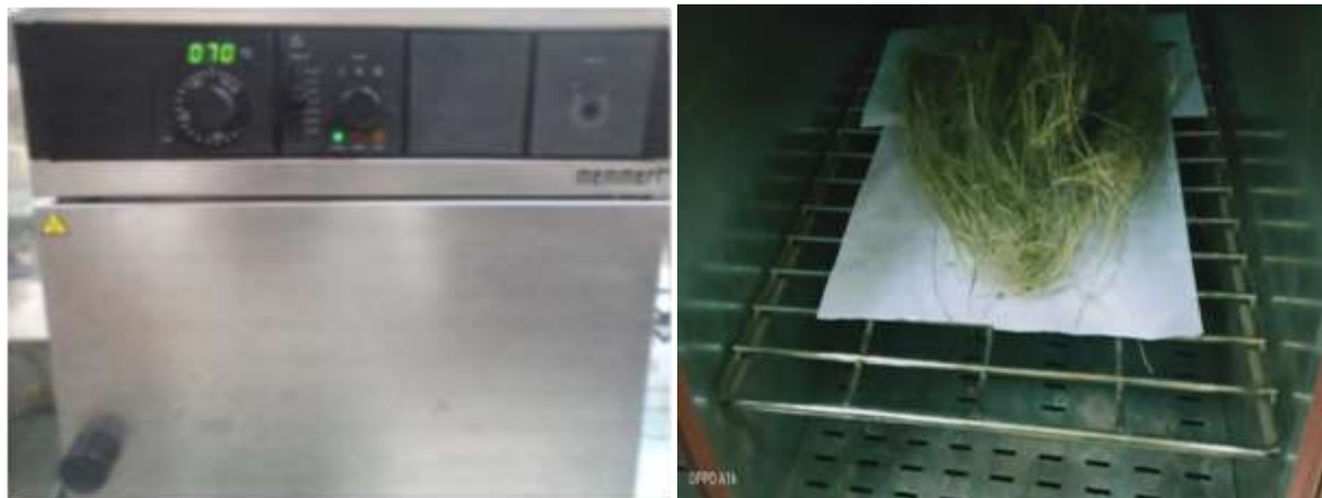
Figure. III. 3. Traitement thermique : l'étuvage des fibres d'eucalyptus
