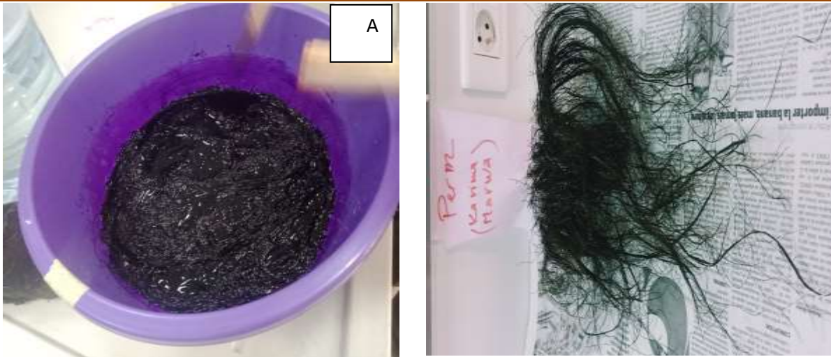
Figure. III.6. Traitement alcalin par permanganate potassium ( \text{KMnO}_4 ) :
