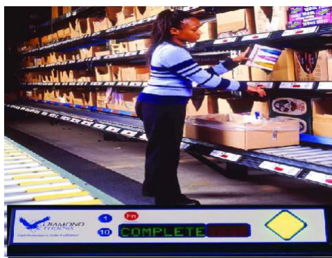
Figure 2.3 : Le mode de préparation assistée « Pick to Light »
