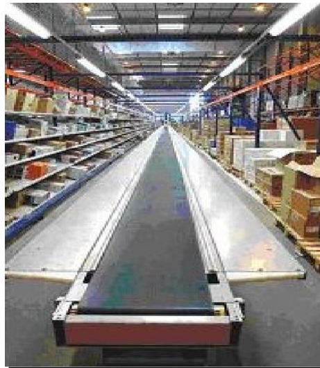
Figure 2.4 : Le mode de préparation « Pick to belt »
