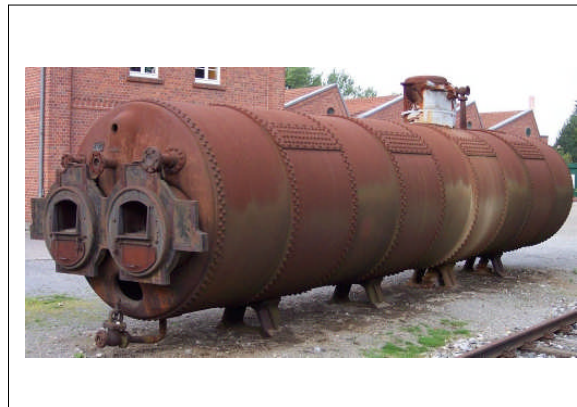
Chaudiere a vapeur
