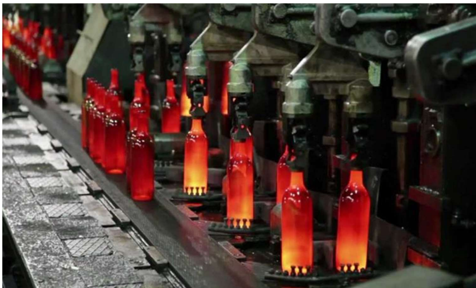
Figure III.9 : Formage du verre dans une machine IS.
