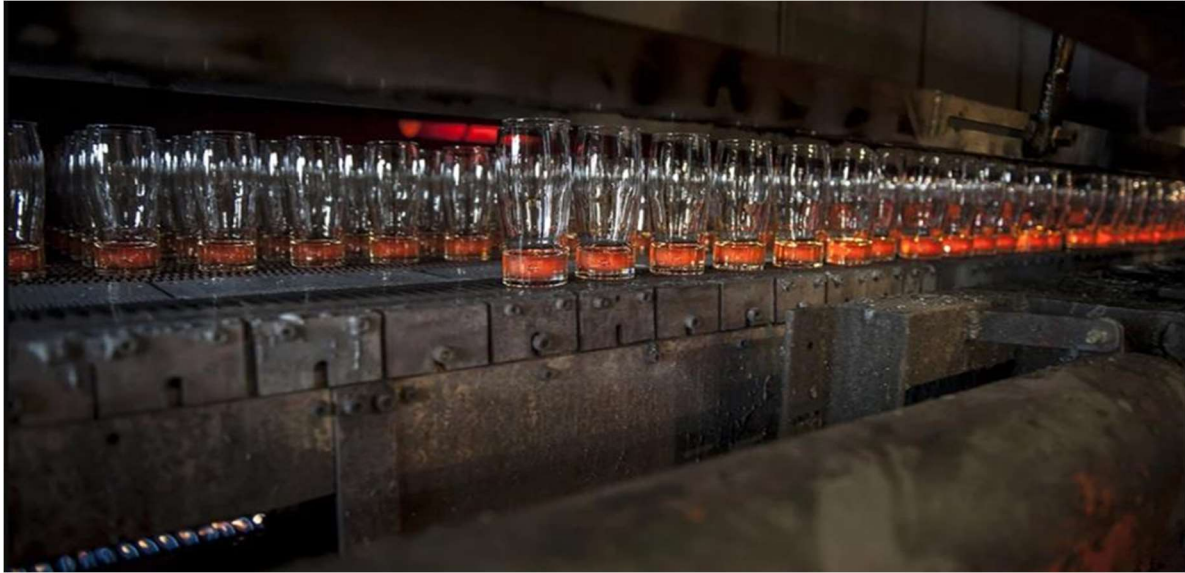
Figure III.10 : Recuison des produits en verre .
