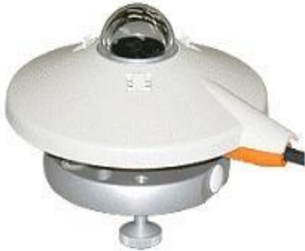
Fig IV.16. L'instrument qui meure le rayonnement global ; Pyranomètre
