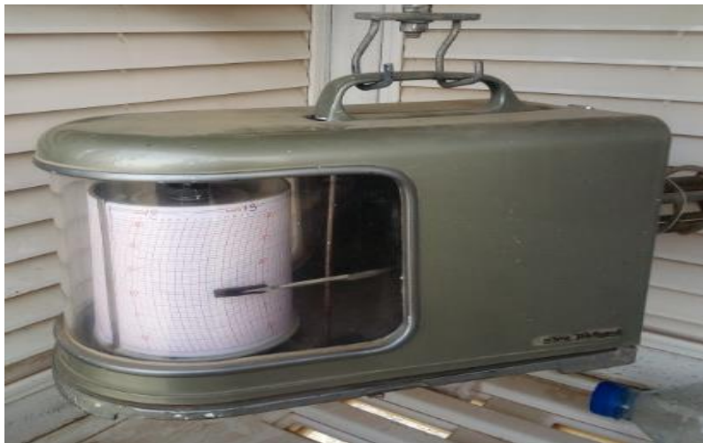
Figure(IV.5) thermographe de l'abri météorologique.
