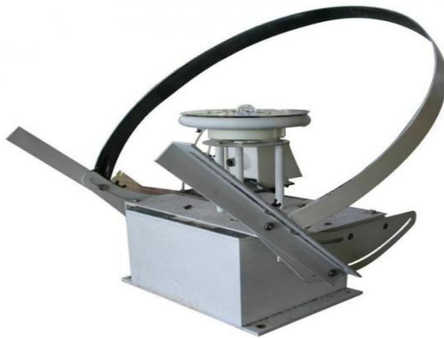
Fig IV .15. L'instrument qui mesure le rayonnement diffus ; Pyranomètre
