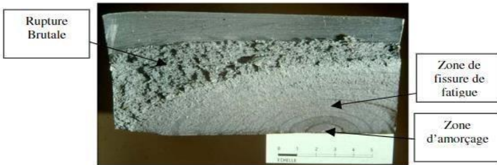
Fig. II.1 : Faciès de rupture
