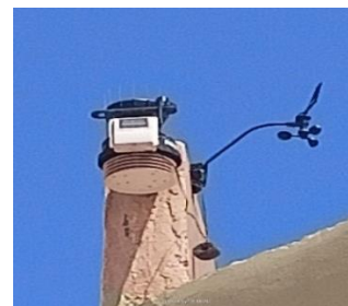
Figure III.2 Station météo de marque Vantage Pro2.
