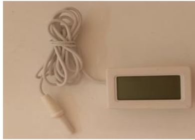
Figure III.3 Thermomètre digital de type TP2.
