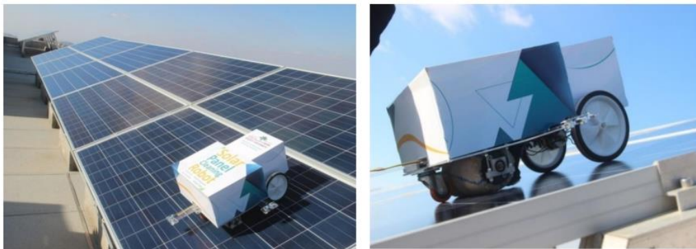
Figure II.10 Nettoyage intelligent des panneaux solaires
