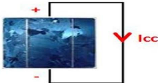
Figure I.9 Courant de court-circuit
