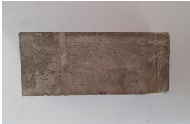
Figure II.2: Photographie représentant les blocs Mg-RE utilisés.
