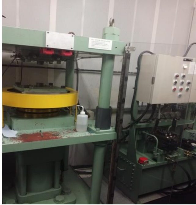
Figure II.3: Photographie de la machine HPT utilisée dans ce présent travail (Faculté d'Ingénieur et de l'Environnement, Université de Southampton, Angleterre).
