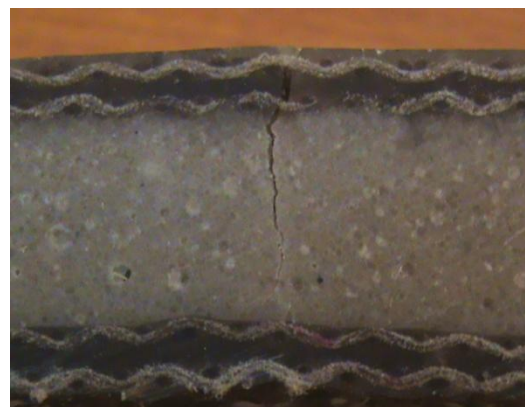
Figure .V.7 : Faciès de rupture du BP-90
