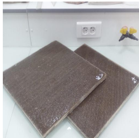
Figure IV.10 : Plaque de béton polymère : polyester /silice /marbre/jute.
