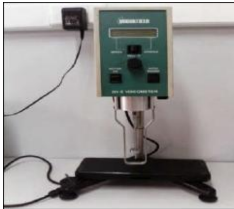
Figure. IV.1. Appareil pour la mesure de la viscosité.
