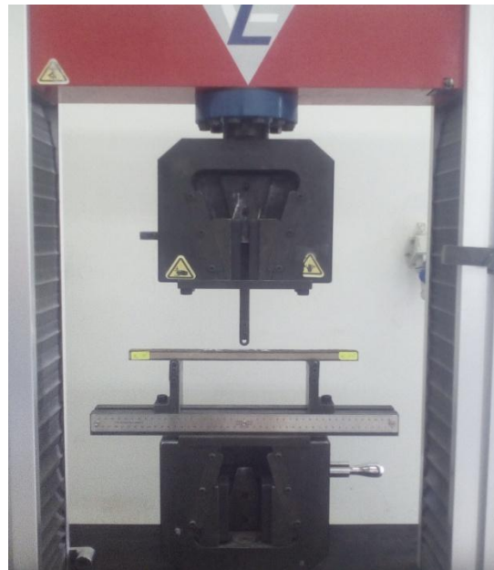
Figure IV.14 : Machine d'essais YL Universel Testing Machines /20kN.
