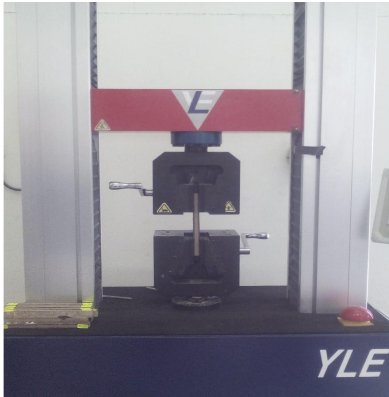
Figure IV.15 : Machine d'essais YL Universal Testing Machines /20KN.
