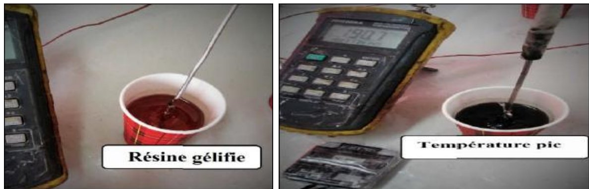
Figure. IV.2. : Test de réactivité de la résine.
