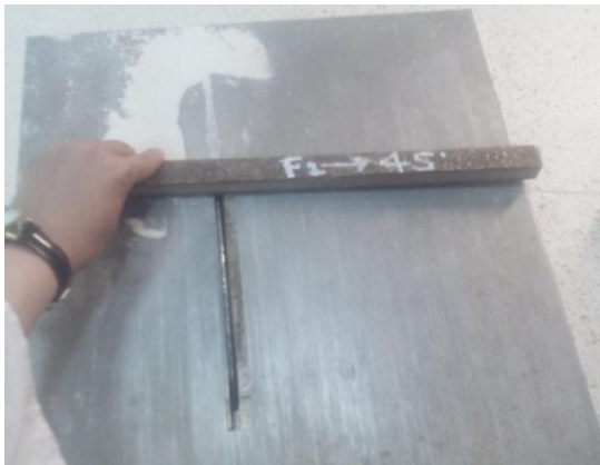
Figure IV.11 : Découpage des éprouvettes.
