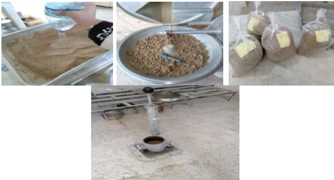
Figure III.3 : Préparation des essais de compactage
