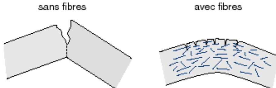
Figure II.4: Principe du fonctionnement des fibres dans le béton
