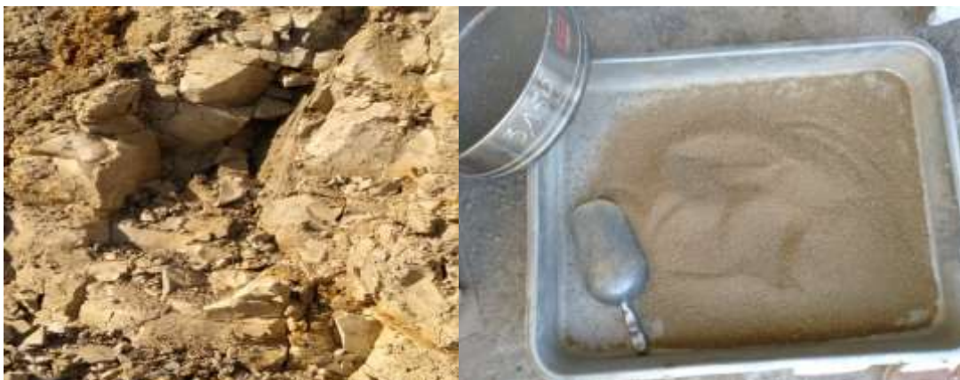
Figure III.1 : Aspect du sol de Sidi Hadjres a) intact, b) broyé
