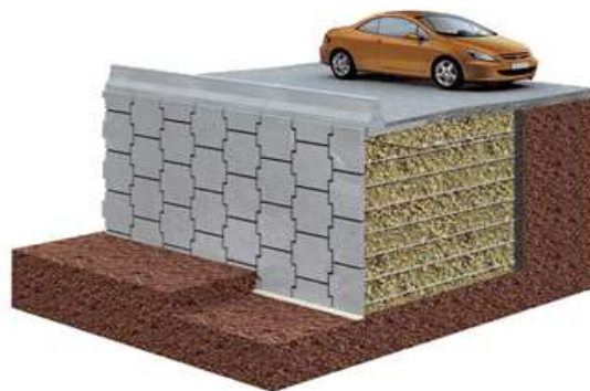
Figure I .2 : schéma de principe de terre armée
