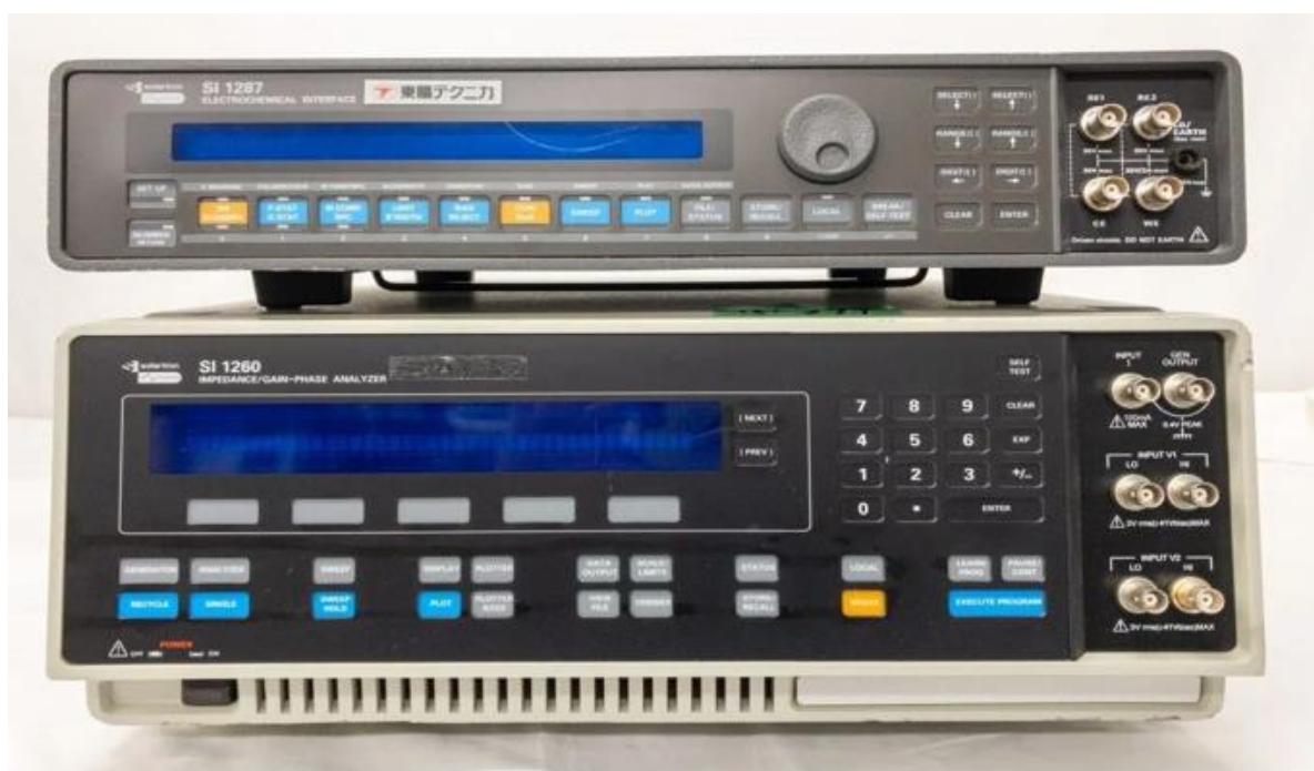
Figure II.2 : Dispositif constitué d'un potentiostat modèle Solartron 1287 associé à une impédance mètre de type Solartron 1260.
