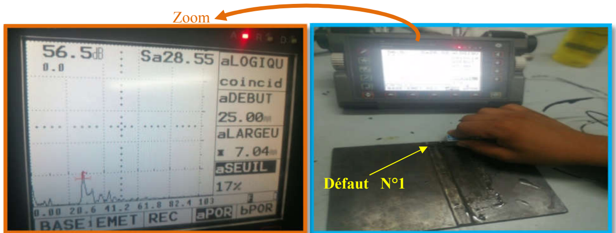
Figure III. 49 Recherche du deuxième défaut.
