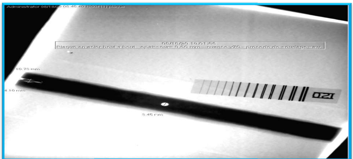
Figure IV. 2 Image d'interprétation des défauts dans le cordon de soudure.
