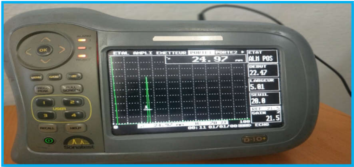
Figure III. 12 Vérification de la linéarité verticale.
