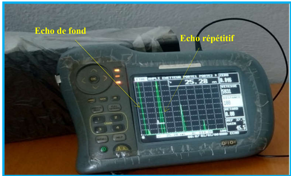
Figure III. 8 Echo de fond et répétitif.
