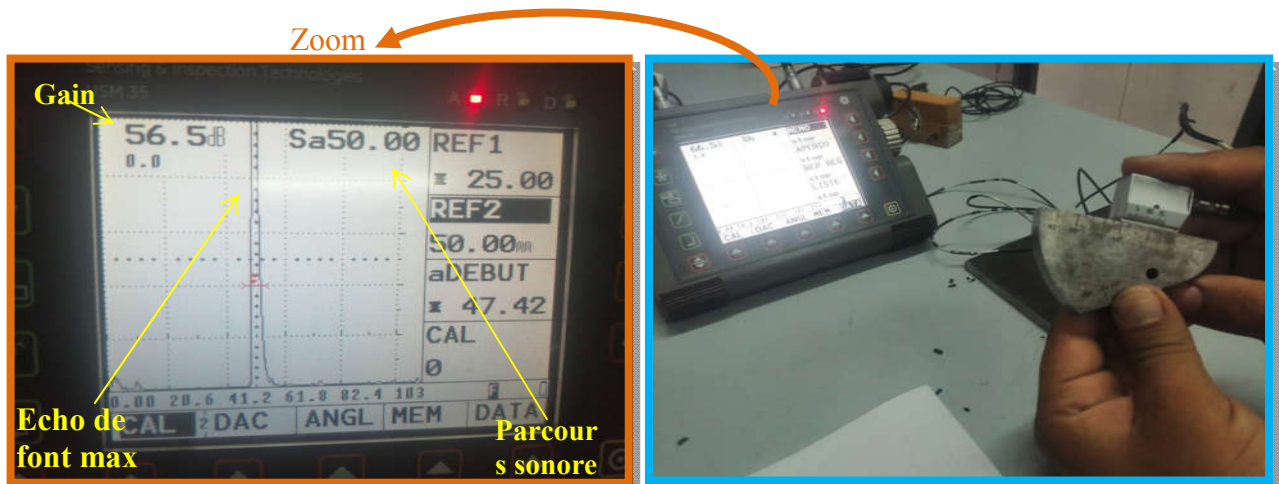
Figure III. 44 Étalonnage de l'appareil à ultrasons par palpeur angle.
