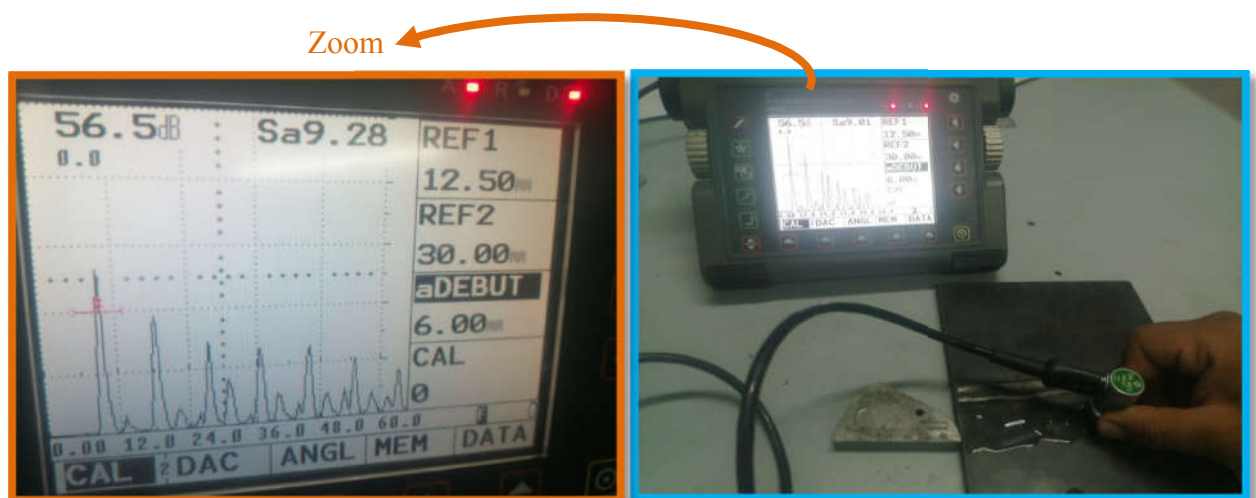
Figure III. 46 Balayage par palpeur droit.
