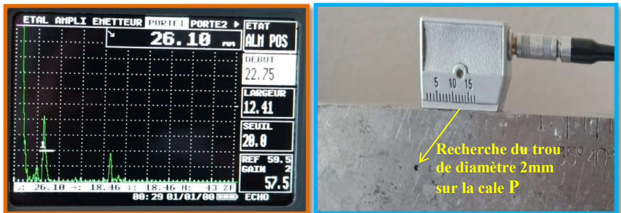
Figure III. 24 Recherche du trou de diamètre 2mm sur la cale.
