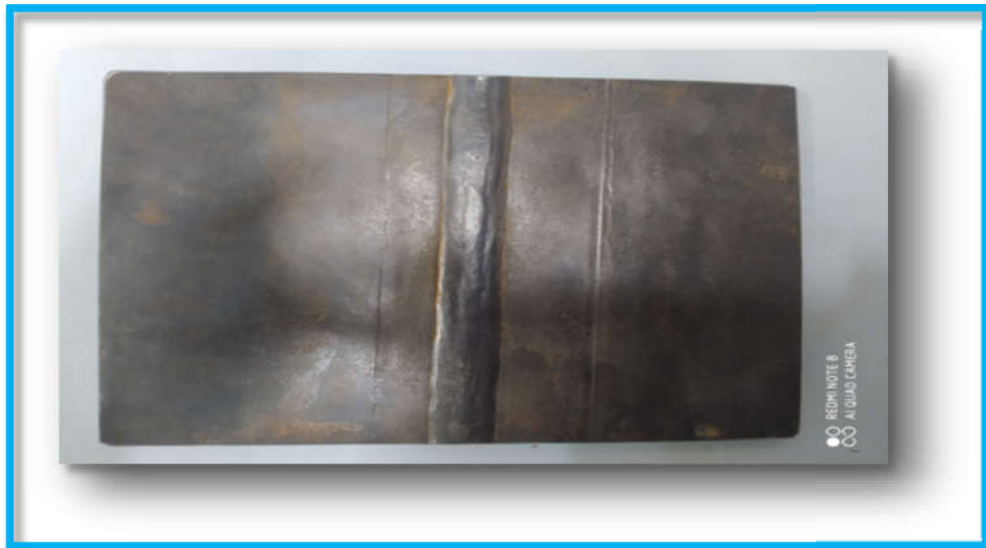
Figure III. 37 Plaque en acier assemble par soudage.
