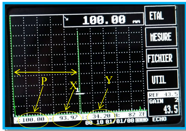
Figure III. 18 Echo détermination de point d'émergence
