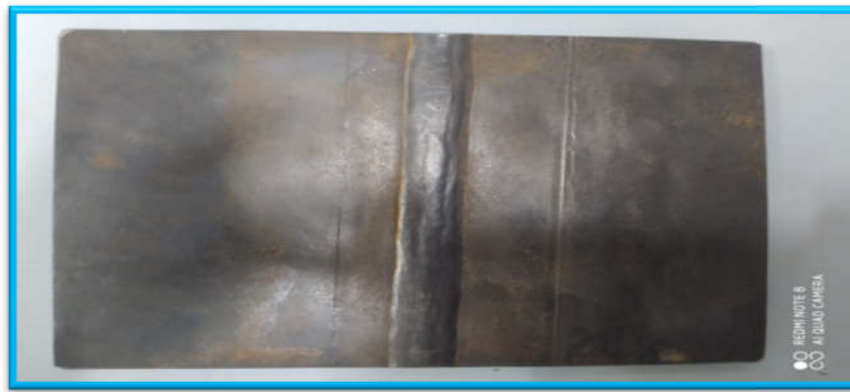
Figure IV. 4 Plaque acier assemblage bout à bout sans défaut.
