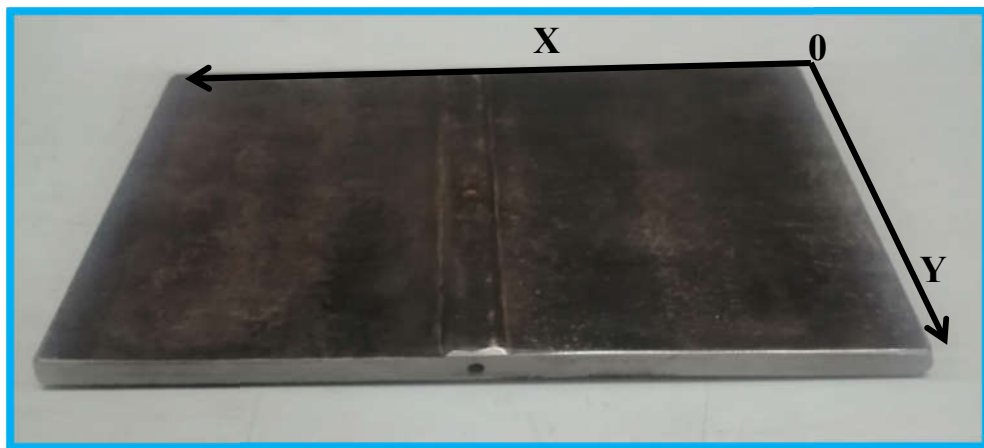
Figure III. 38 Création des défauts sur la plaque acier.
