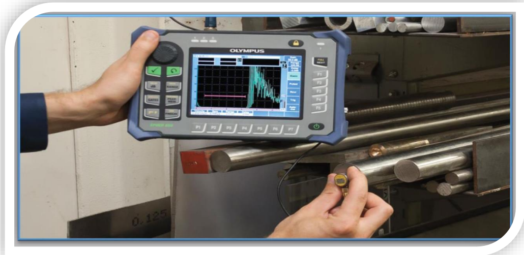
Figure I. 11 contrôle non destructif par L'Ultrason, [2] .
