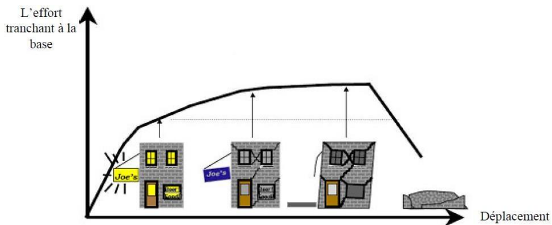
Figure III.2 Représentation des niveaux d'endommagements décrits par une courbe de capacité.
