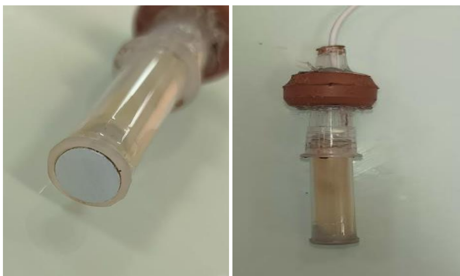
Figure II. 4 : Photo de l'électrode de travail (disque d'aluminium)
