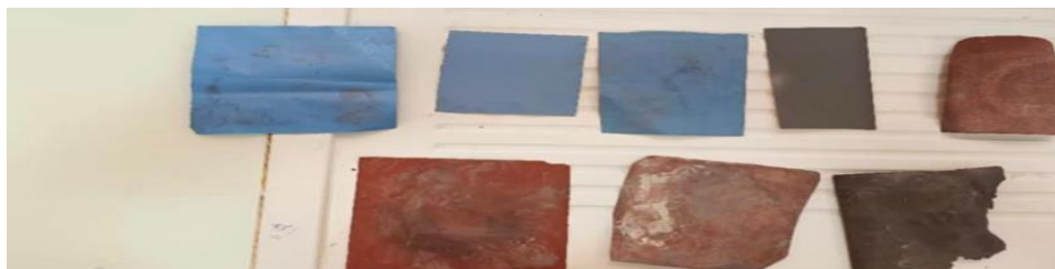
Figure II. 2 : Papiers abrasifs utilisés pour le polissage des électrodes d'aluminium
