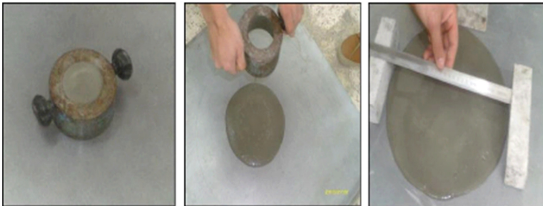
Figure 1-13 : Étalement au Mini cône de mortier autoplaçant
