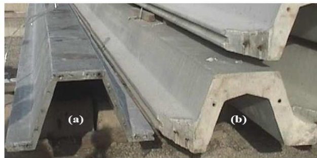
Figure 2-12: Palplanches précontraintes à base de : mortier autoplaçant fibré (a), béton armé ordinaire (b)
