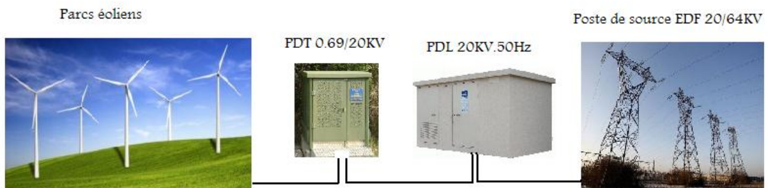
Fig.IV.2: Schéma de principe du raccordement des éoliennes au réseau.
