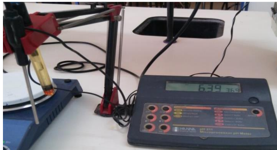
Figure 3.2 : pH-mètre (HANNA instrument 211)
