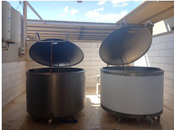
Photo 7. Cuves de collecte du lait cru
